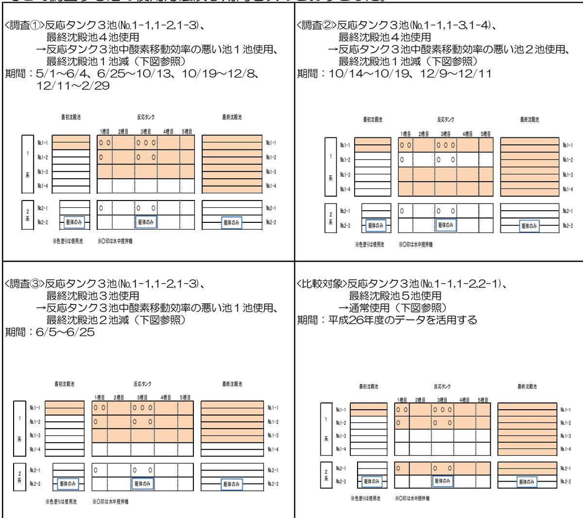
また、放流水質の調査項目をSS、BOD、窒素含有量、りん含有量とし、電力量については送風機棟、水処理棟及び二棟の合計き電力量とした。
